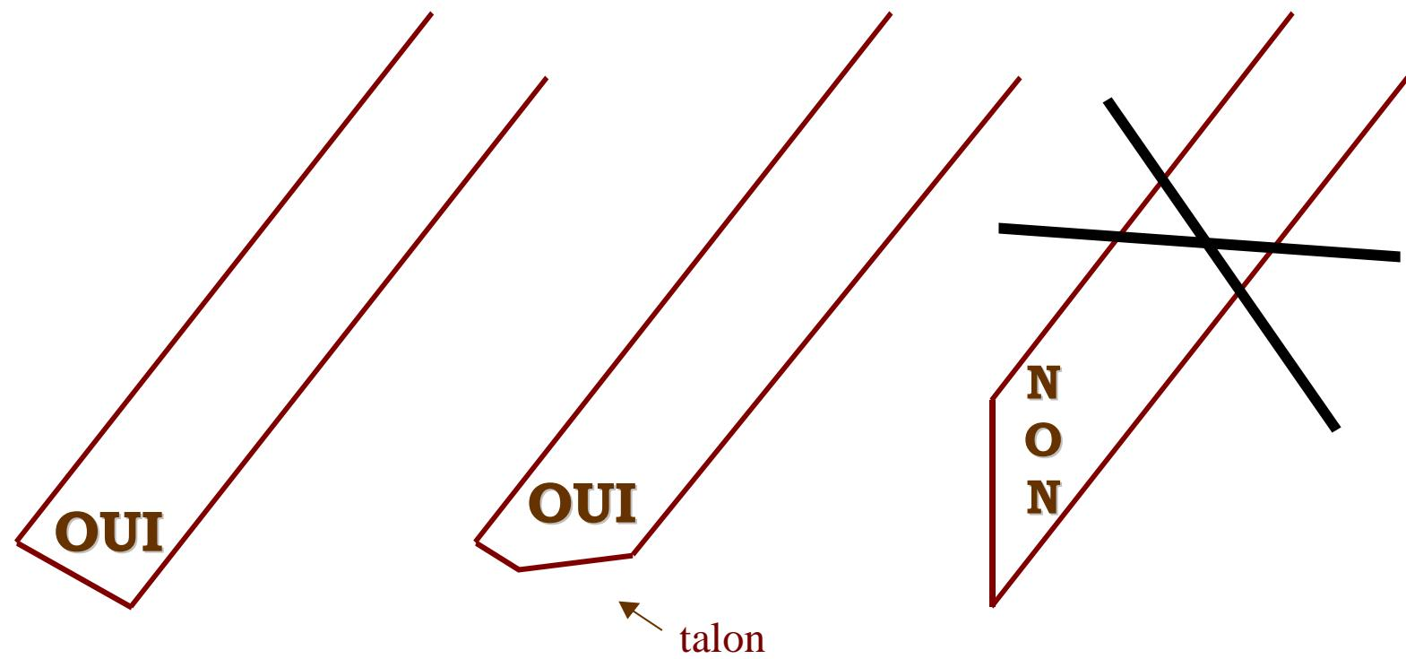
Sur un bâtiment ancien, quelle que soit la pente de la toiture, chevrons ou coyaux sont toujours coupés perpendiculairement au fil du bois, souvent avec un talon, mais **jamais verticalement** (à l'aplomb).
